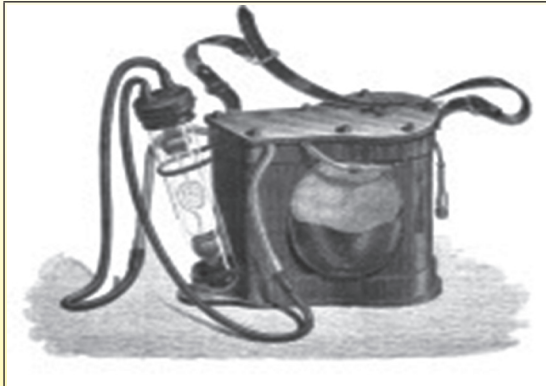
1862 Dumas et Benoît's Electrical miner lamp
